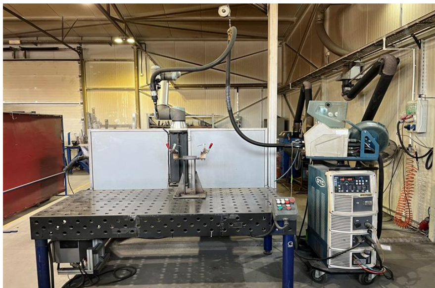
Slika 2 Prikaz radnog mesta za robotsko zavarivanje
