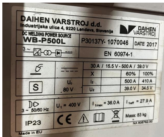
Slika 3 Tehničke karakteristike uređaja za zavarivanje
