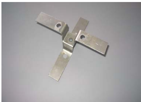
Slika 10. Izgled krstasto zavarenih epruveta različitih debljina
