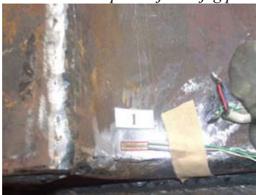
Slika 3. Statička ispitivanja - merno mesto br. 1
