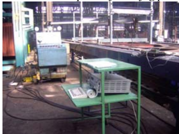
Slika 2. Statička ispitivanja donjeg postolja
