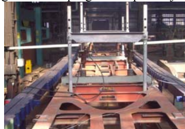
Slika 1. Statička ispitivanja donjeg postolja
