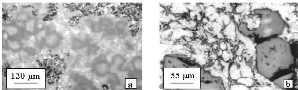
**Figure 8:** Composites: a) ZA27 + 3 wt.%  $\text{Al}_2\text{O}_3$ , 12  $\mu\text{m}$ , SEM, b) ZA27 + 3 wt.%  $\text{Al}_2\text{O}_3$ , 250  $\mu\text{m}$ , OM.
